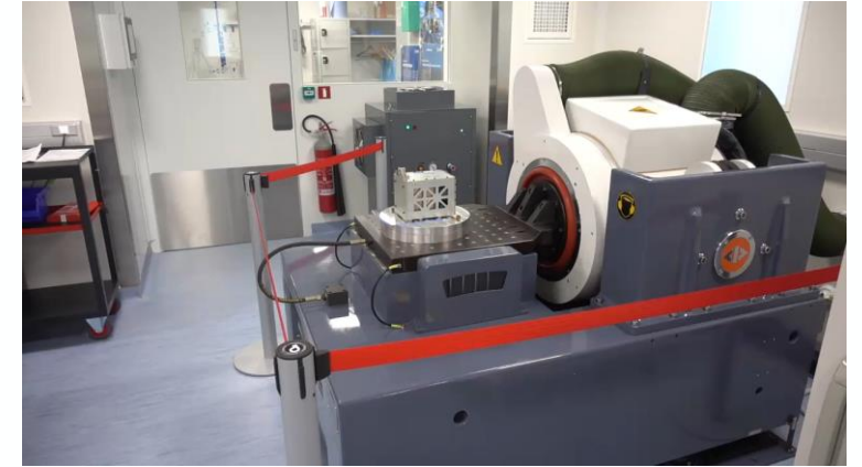
ISTsat SpareSat Random Vibration Test (Aug 2022)
